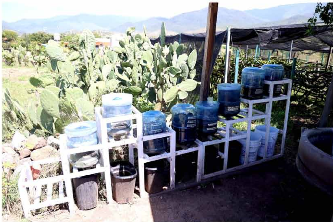
Filtros caseros elaborados con garrafones de agua. Cortesía
